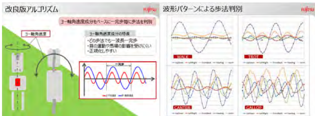
図 3 ヨー軸加速度成分をベースとした歩法判別
